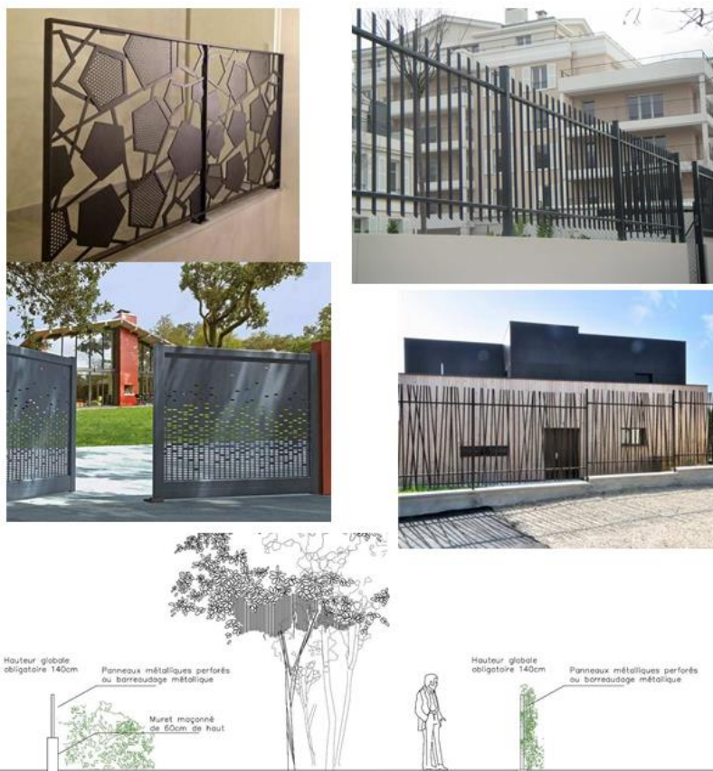
Images de références et coupe type pour l'aménagement des clôtures de type 1
